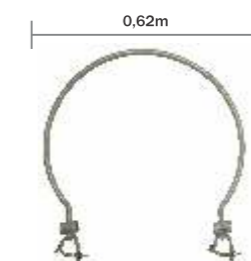
Descrição Guarda-corpo sem degrau
